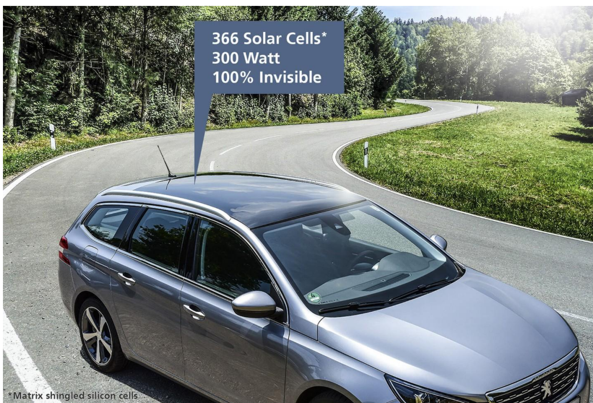
10. ábra: napelemmel felszerelt elektromos autó. Az autó tetejébe láthatatlanul integrált napelemek nagy teljesítményű energiatermelést biztosítanak (Heinrich, dátum nélk.).
