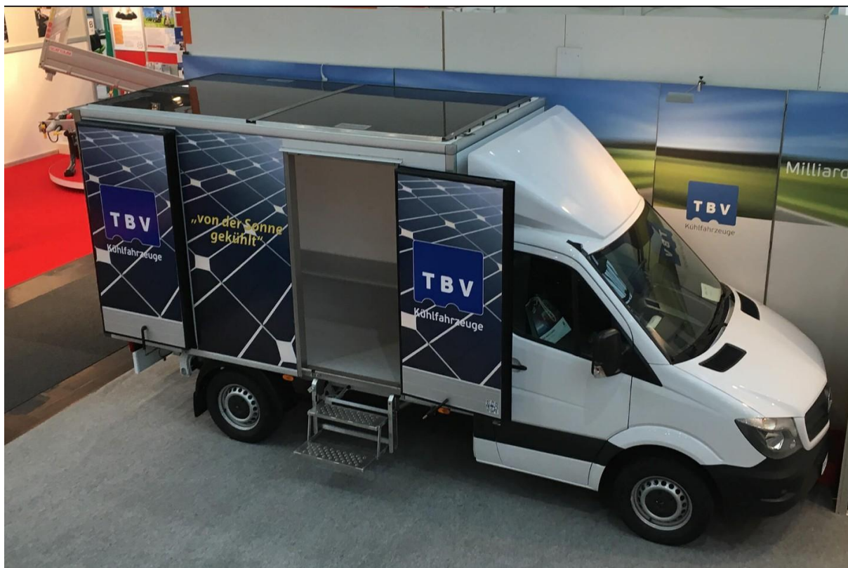
11. ábra: Hűtött furgon a TBV-től: Itt egy hűtőkamra készült, amely integrált PV moduldal támogatja a rekesz hűtését (Heinrich, dátum nélk.).
